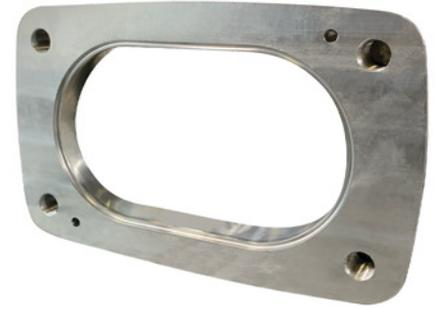
Der **STANDARD-PUMPENDECKEL** ist so optimiert, dass das Produkt schonend vom Einlassrohr zum Förderbereich der Spindeln transportiert wird. Die stromlinienförmige Konstruktion ohne Abrisskanten verbessert die Saugeigenschaften der Pumpe (NPSHr) erheblich. Jede Pumpendeckel ist mit einem Aseptoflex-Anschluss ausgestattet, an dem ein IFM-Vakuummeter bündig montiert werden kann.
