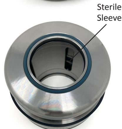
Die mit Huhseal AB in Schweden neu entwickelten Gleitringdichtungen aller **ViscoTwin G10** Modelle sind nun äusserst einfach und zuverlässig einzubauen. Alle Stifte und Pins wurden eliminiert. Ueber "Flats" werden die Statoren positioniert und die Dichtung von Hand axial in Position gepresst. Bei doppelt wirkenden Gleitringdichtungen wird das Spülwasser über die "Sterile Sleeves" in der Cartridge zugleich fuer die Wellenkühlung verwendet.
