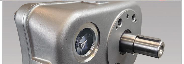
Dank des mitgelieferten Wellenblockierwerkzeugs kann der Servicetechniker die Antriebswelle blockieren und somit beide Spindelbolzen sicher und ohne Probleme lösen und wieder montieren.
