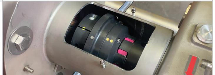
Über die Synchronisieröffnung kann der Servicetechniker die Wellen in nur 10 Minuten synchronisieren. Es müssen keine Pumpenteile demontiert und kein Getriebeöl freigesetzt werden.
